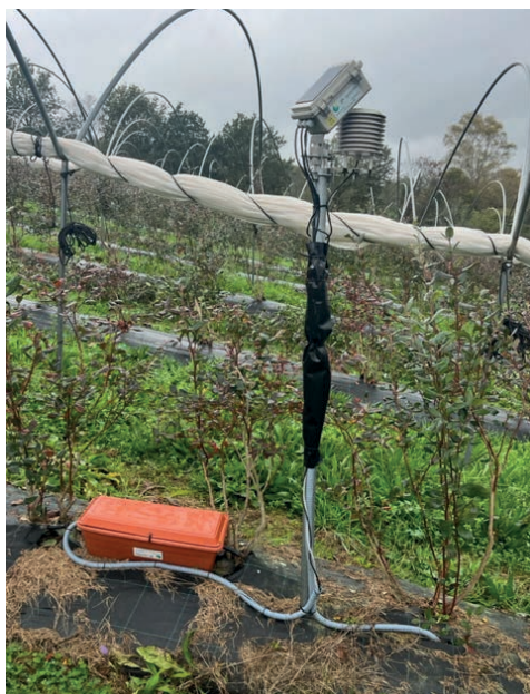
Estación meteorológica y de control de riego.
