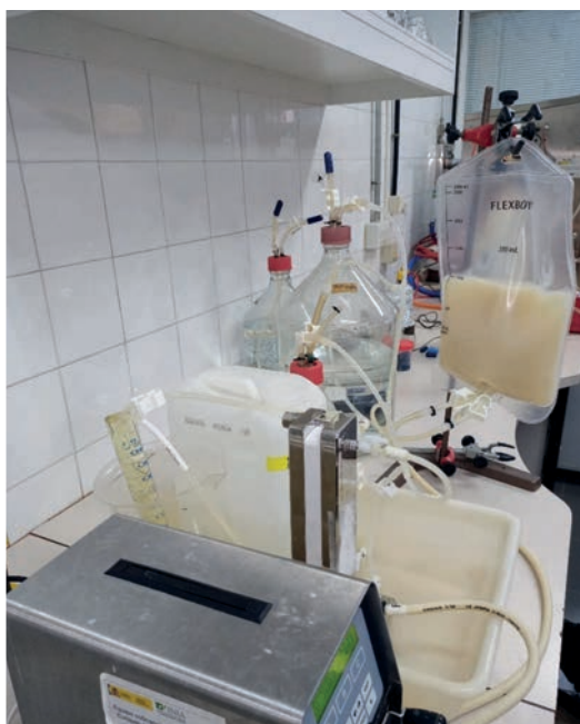
Figura 54. Concentración de biomasa producida de levadura mediante filtración por flujo tangencial
