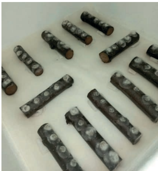
Figura 38. Madera infectada con la cepa LPPAF-988 en el ensayo de efectividad del tratamiento con calor para eliminar el patógeno
