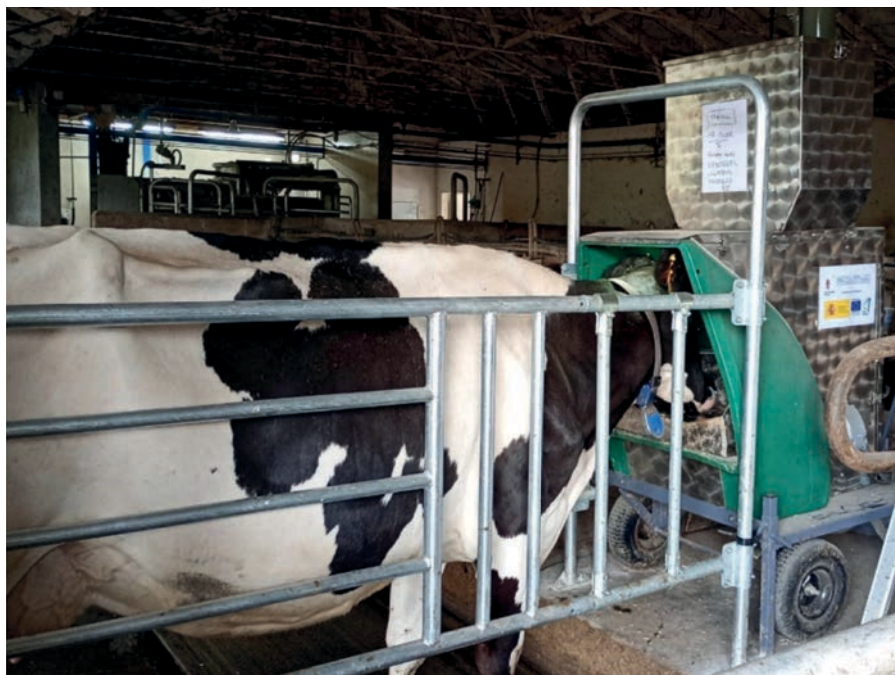
Figura 42. Uso del equipamiento GreenFeed para determinar la producción de gases de efecto invernadero de las vacas según el tipo de alimentación
