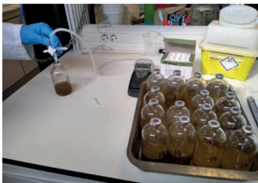
Figura 36. Toma de medida de la presión de gas en el ensayo in vitro .
