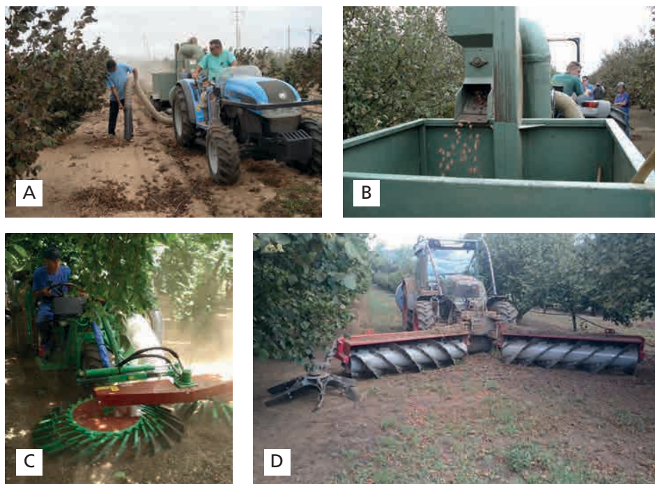
Figura 21. Diferentes equipos usados en la recolección de la avellana. A, B: máquinas aspiradoras. C, D: Máquinas integrales (Imagen de P. Arbonés).
